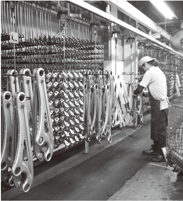
被塗部品をハンガーに掛け、全195m・約2時間半の塗装工程の開始
