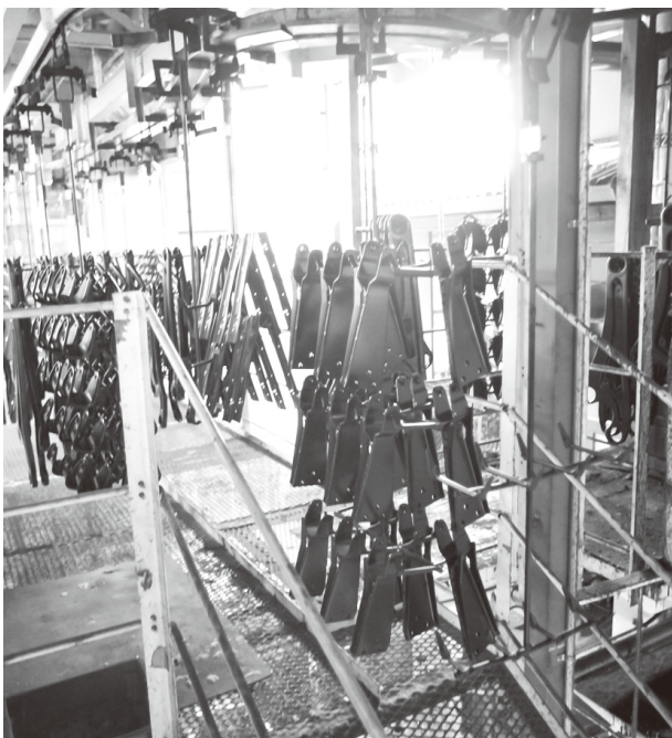
塗装された部品は次工程へ。工場内を移動中に乾燥させる
