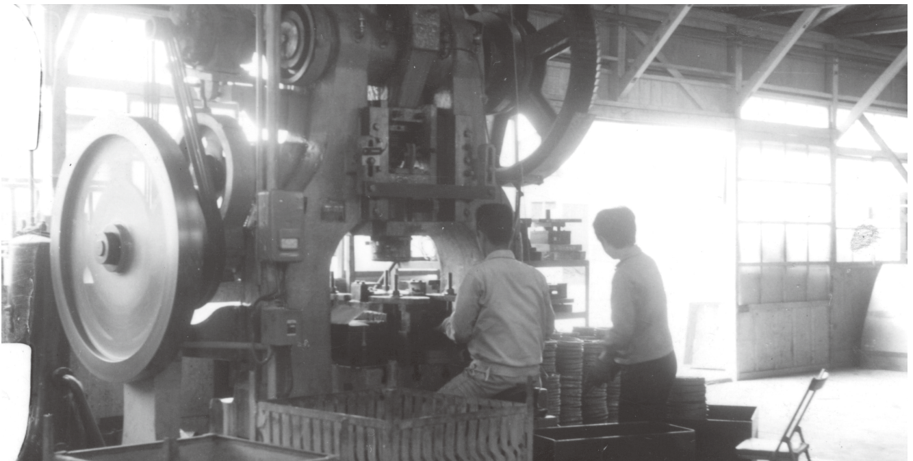
南工場1号棟の120tポンチングマシン(プレス機)
