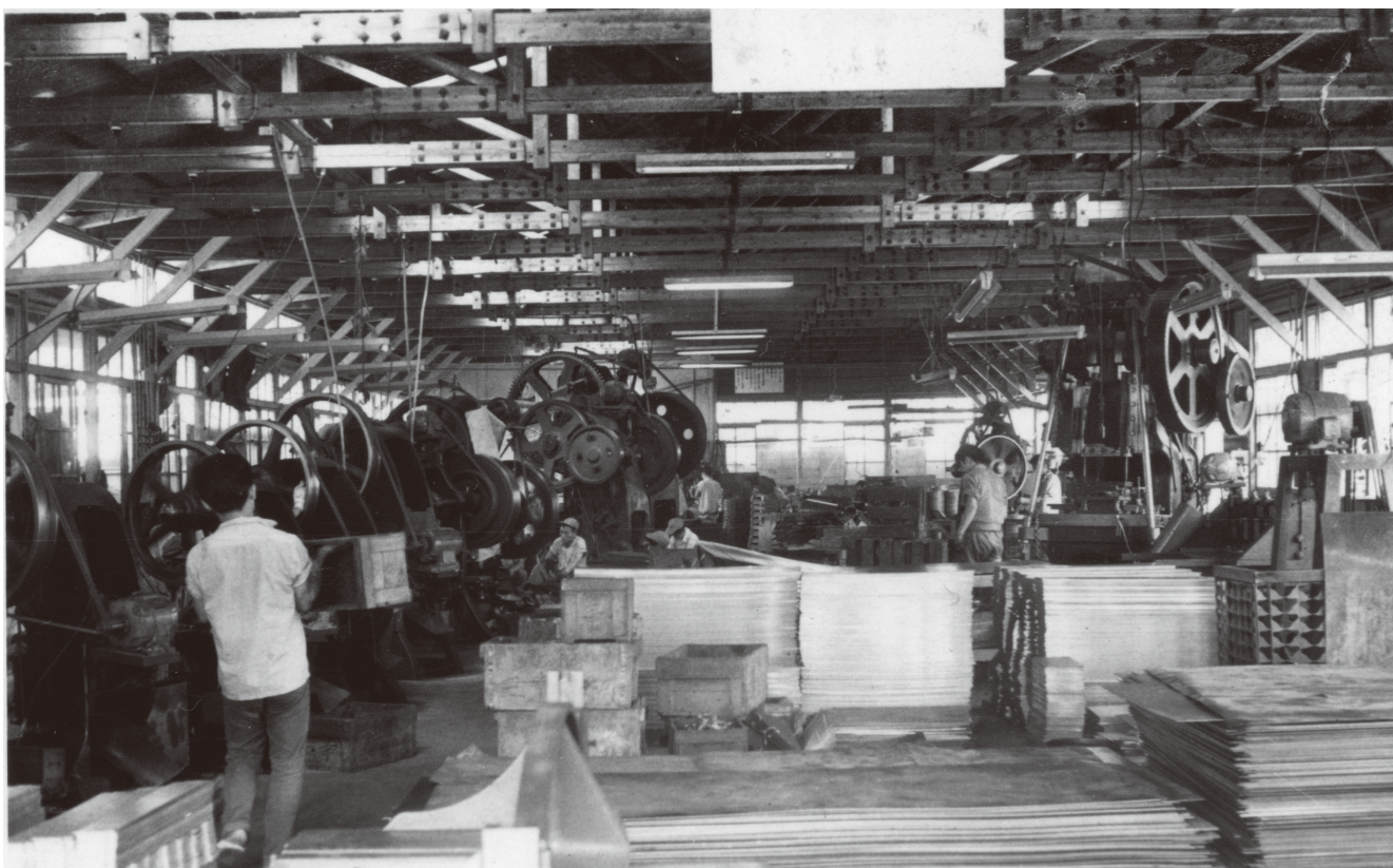
1959年(昭和34年)竣工の南工場1号棟。ポンチングマシン導入による生産体制を強化
